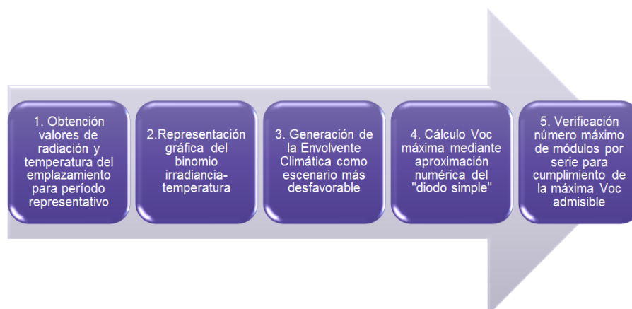
Figura 1. Procedimiento de dimensionamiento del número de módulos máximo por string
